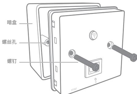
2 请将墙壁中的网线接上水晶头，并将其插入背面板相应接口；
