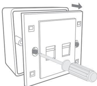
3 对设备与暗盒上的螺丝孔，装入螺钉以固定，请勿将螺钉拧得过紧。
